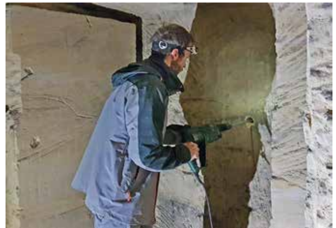
Placing temperature sensors in Gemeentegrot. Photo Joep Orbons
